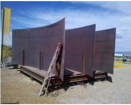
Fabricación de placas para tanques de lixiviación.
