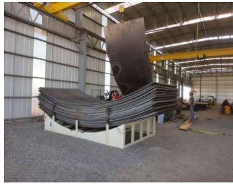
Fabricación y doblado de placas para tanques de lixiviación.
